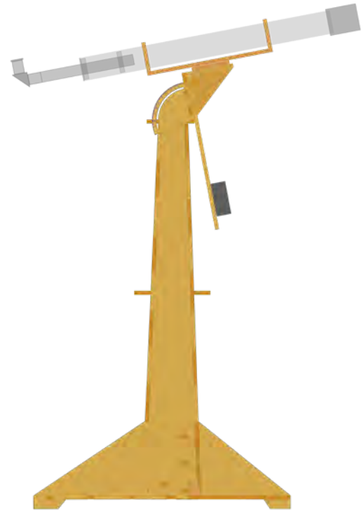
Esquema montura ecuatorial para telescopio refractor realizado por Enrique Torres
