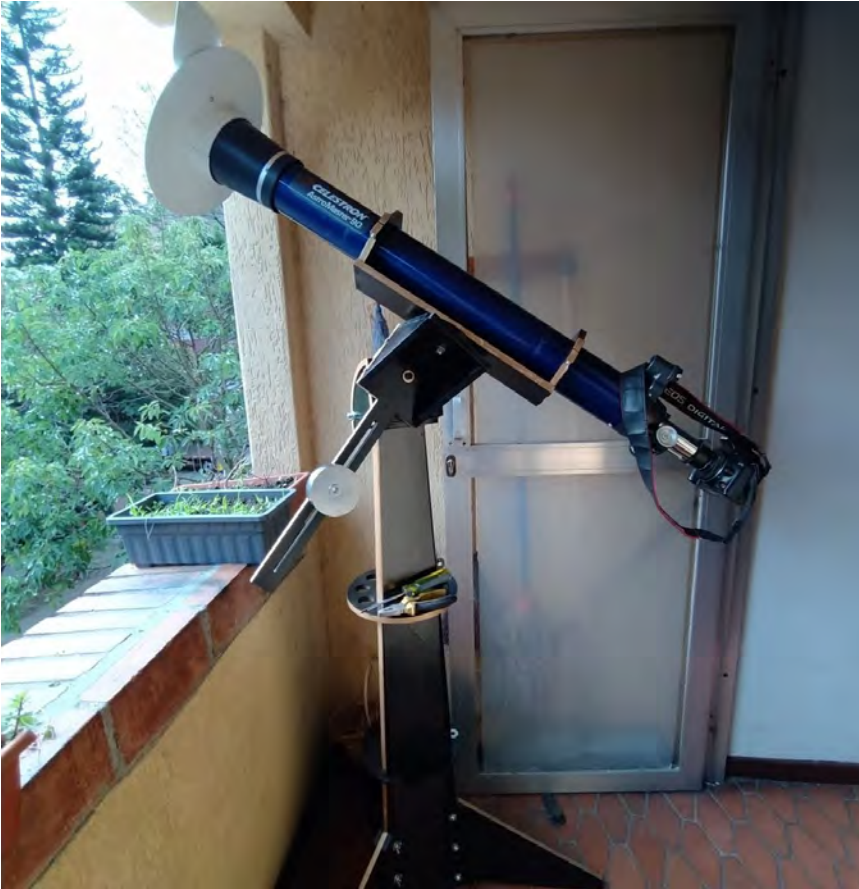
Montura ecuatorial telescopio de Enrique Torres con telescopio refractor y cámara reflex
